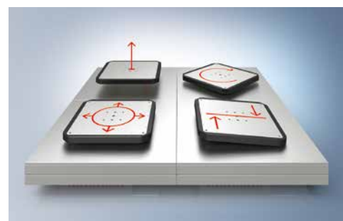
Le secret qui se cache derrière le système de transport flexible XPlanar est la lévitation magnétique qui assure des mouvements totalement libres aux movers dans les directions X, Y et même Z en partie.
